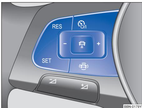
图 146 多功能方向盘左侧：自适应巡航系统（ACC）
