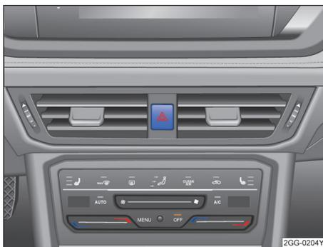
图 40 在中控台上部分中：危险警告灯开关
