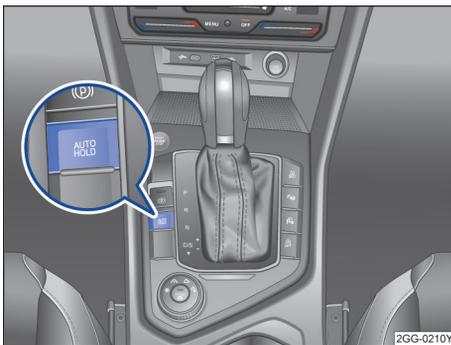
图 112 在中控台中：自动驻车功能按钮
