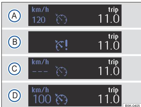
图 140 组合仪表显示屏：定速巡航系统状态显示模式
