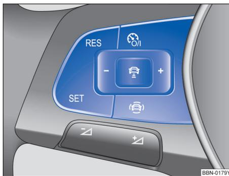
图 18 多功能方向盘左侧的驾驶辅助系统操作按钮
