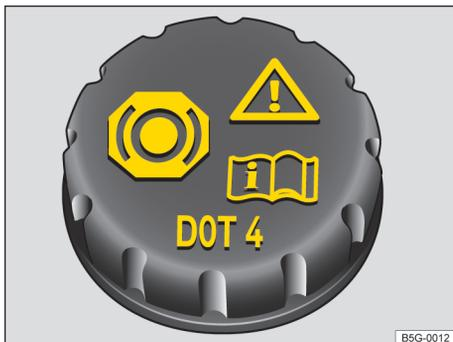
图 207 发动机舱内：制动液容器的盖子。
