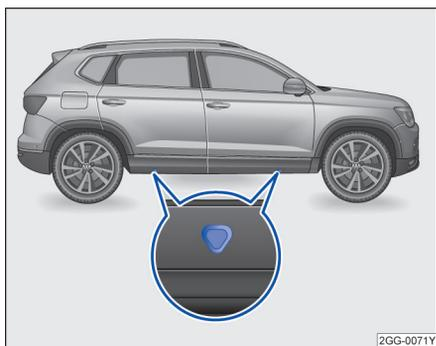
图 215 汽车千斤顶的支撑点
