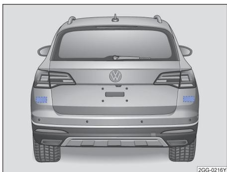
图 155 车辆后视图：雷达传感器部位
