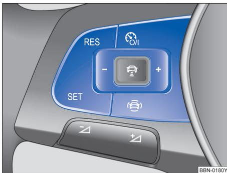
图 142 多功能方向盘左侧：车速限制器操作按钮
