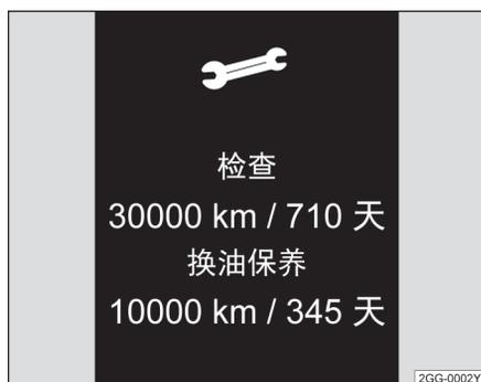
图 15 示意图：保养信息组合仪表显示屏显示示例
