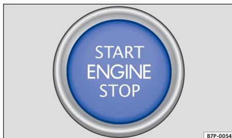
图 105 无钥匙系统 Kessy：中控台上的启动按钮。
