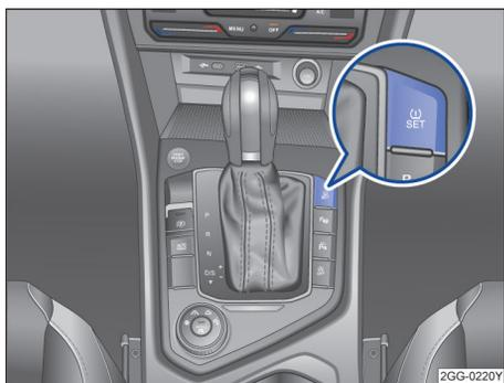
图 208 被动式轮胎气压监控系统设定按钮
