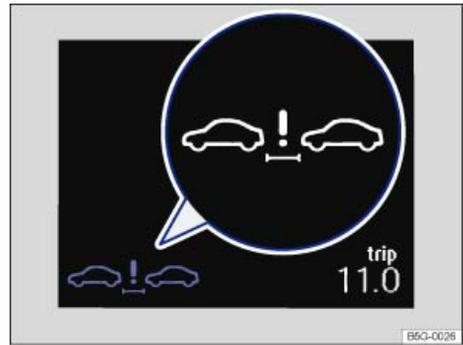
图 149 组合仪表显示屏中：车距预警显示
