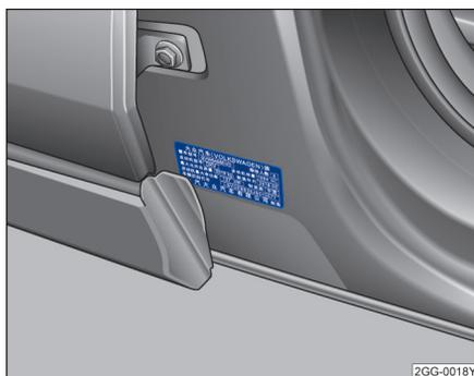
图 220 B 柱下方整车产品标牌。
