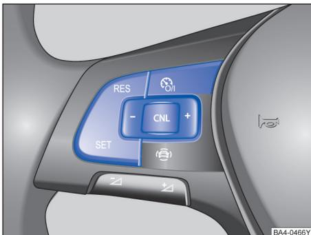
图 139 多功能方向盘左侧：定速巡航系统操作按钮
