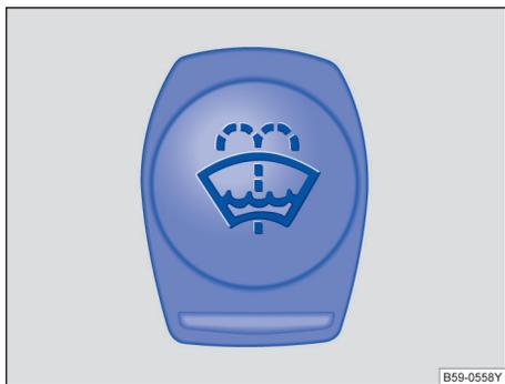
图 203 发动机舱内：车窗清洗液容器盖。
