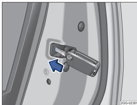
图 54 车门应急上锁装置及汽车钥匙
